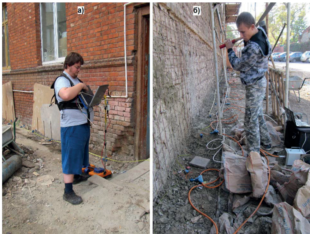
Рис. 6. Условия проведения РЛЗ (а) и МПВ (б) на территории размещения здания МУЗ «Городская поликлиника № 2»
